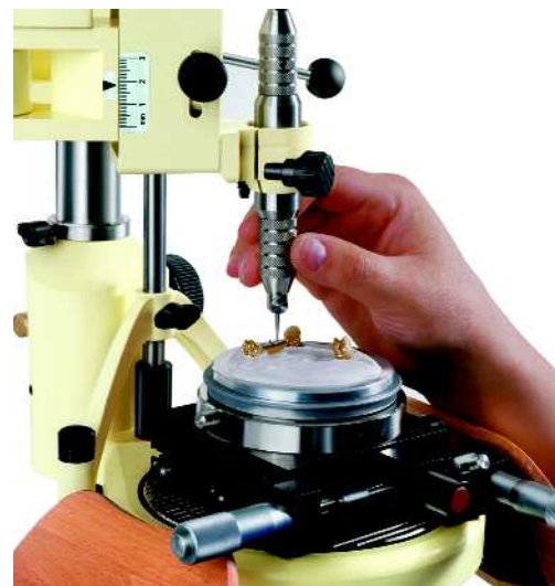
Abb. 23: Die Vermessungsspindel erlaubt Verschraubungen schnell und problemlos herzustellen
