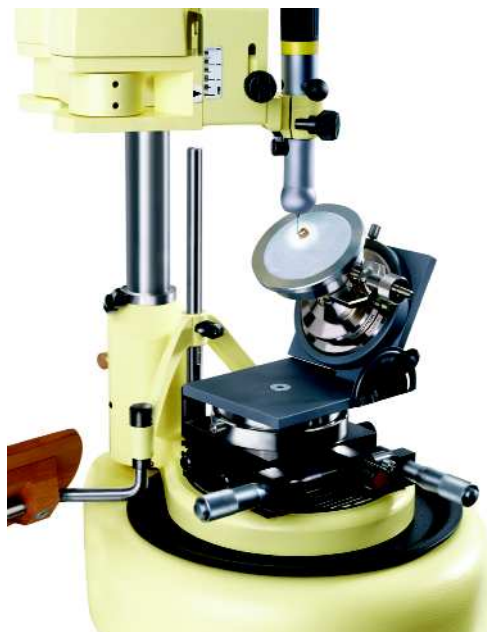
Abb. 22: Durch den verstellbaren Winkeltisch in Verbindung mit dem Koordinatentisch sind Verschraubungen, die nicht okklusal, sondern leicht von palatinal angebracht werden sollten, leicht zu erreichen
