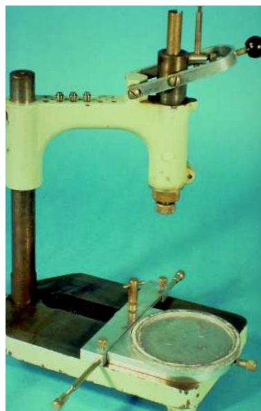
Abb. 9: Fräsgerät nach Fäh um 1955. Neben dem Grundprinzip gab es einen Support mit Verstellungen um 0,02 mm
