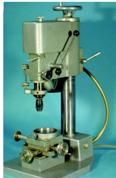
Abb. 10: Fräsgerät mit Motor und Support (Harnisch+Rieth)
