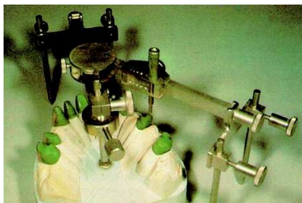
Abb. 1: Parallelofor zum Parallelisieren von Geschiebflächen als Vorläufer der Dentalfräsgeräte
