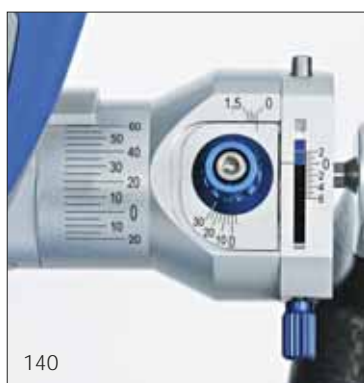
Abb. 140 bis 142 Um alle möglichen Exkursionsbewegungen kontrollieren zu können, sollte der Artikulator in der Lage sein, eine Bewegung nach retral durchzuführen. Der Artex CR lässt eine Retrusion von maximal 2 mm zu, die mit derselben Schraube wie für die Protrusion eingestellt wird
