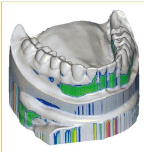
Abb. 11 bis 13 In der virtuellen Welt kann man dann diese Tiefziehfolie ebenfalls sehen. Die Farben signalisieren die Stärke der Abzugskraft. Um gute Erfahrungswerte zu bekommen, sollte man eine Schiene evtl. zwei- bis dreimal mit unterschiedlichen Einstellungen fräsen.
